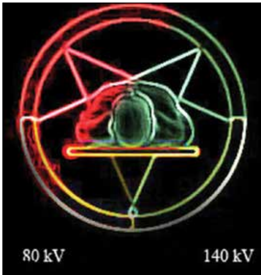
Resim 2. Çift enerjili BT gantrisinin şematik görünümü. Ortogonal yerleştirilmiş, 80 kV ve 140 kV değerlerinde enerji yayan iki tüp mevcut.
